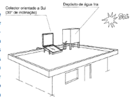
[ FIG. 4.3 ] Localização do colector solar na cobertura do edifício.
